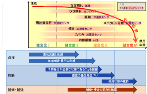
図-3 RC床版のモニタリング技術適用イメージ
