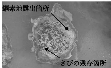
図5 素地調整後のさび残存例
