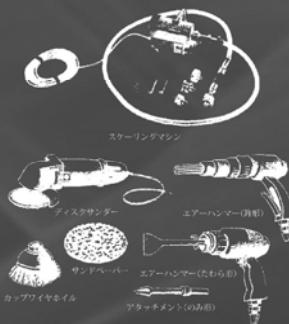
素地調整用動力工具の例
