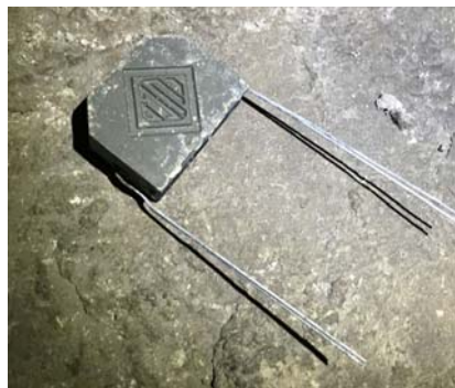
図3.3.2-3 犠牲陽極材と設置状況 1)
