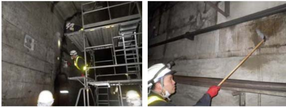
図3.3.2-1 硝酸銀噴霧と打音検査の様子 1)
