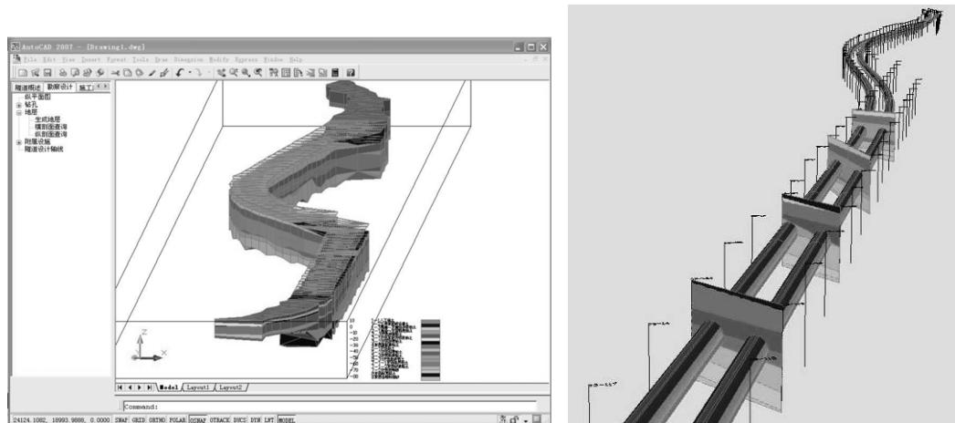
図参7.2 長江横断道路トンネル周辺地盤の3次元モデルおよび横断面図例
