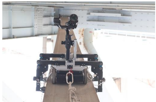
図4-1 点検ロボット
