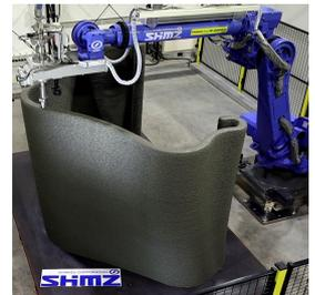
図-4 埋設型枠の製作状況
