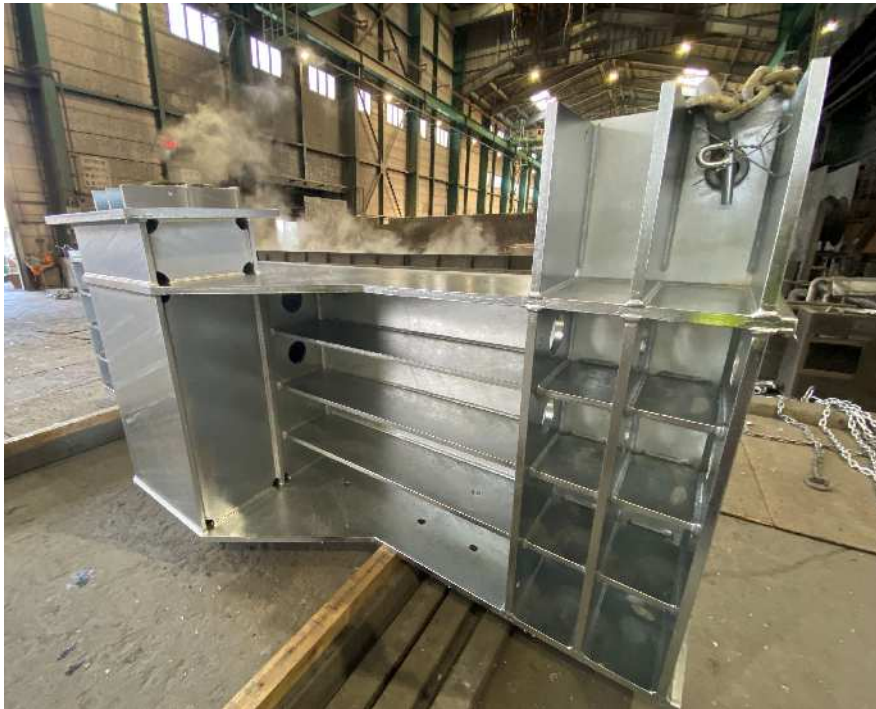
溶融亜鉛めっき処理されたブラケット
