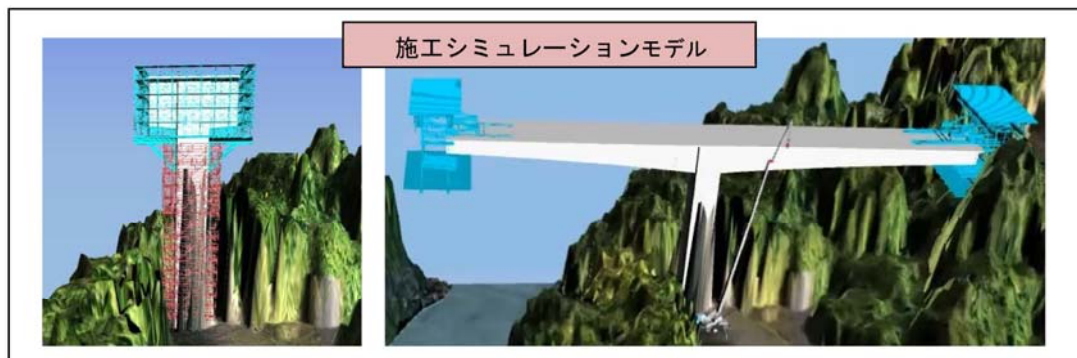
図-7.5.2 BIM/CIM の施工計画活用事例 22)
