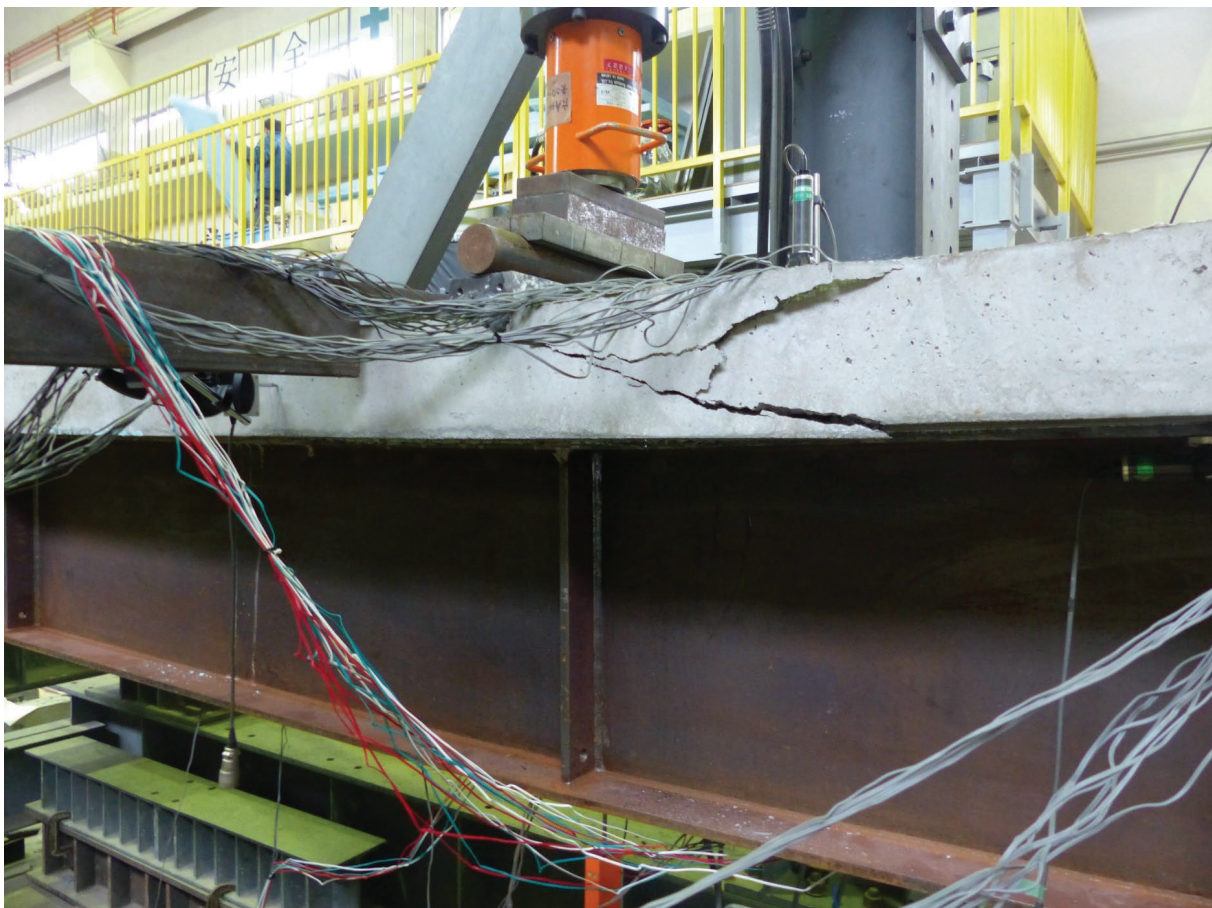
合成梁試験体の破壊状況
