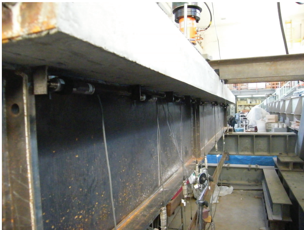
ずれ変位の計測状況
