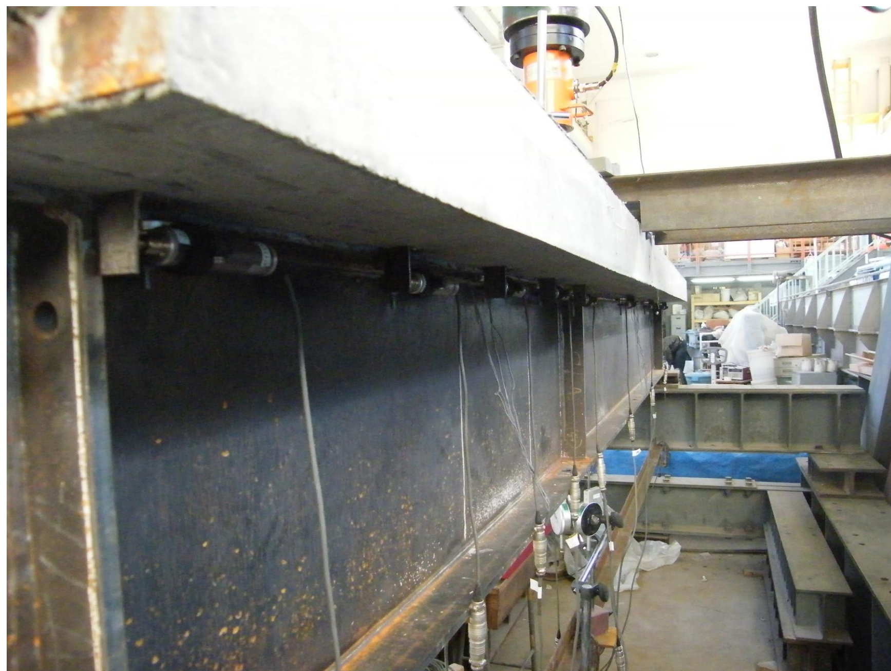
ずれ変位の計測状況
