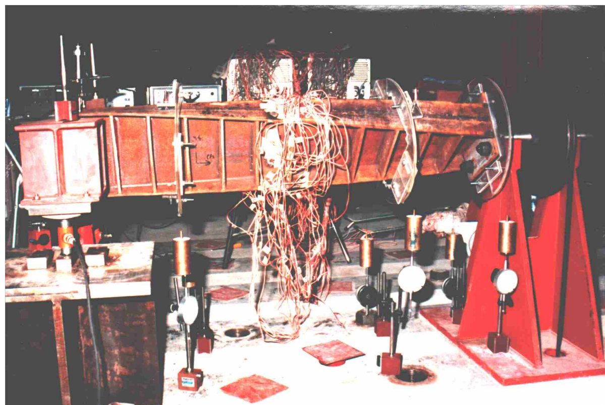
H型鋼のねじり実験
