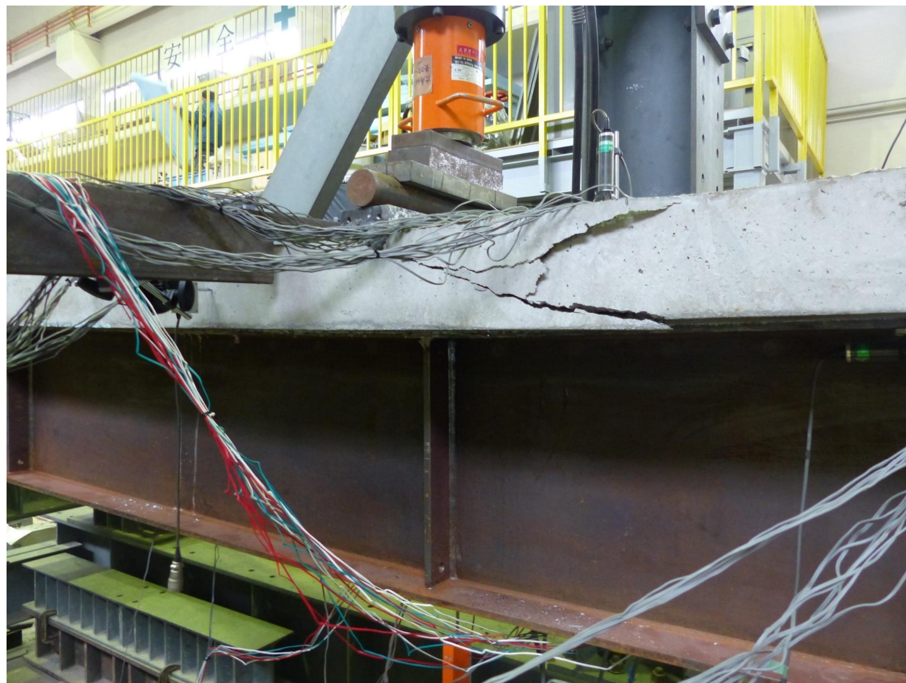
合成梁試験体の破壊状況(床版コンクリートが圧壊)
