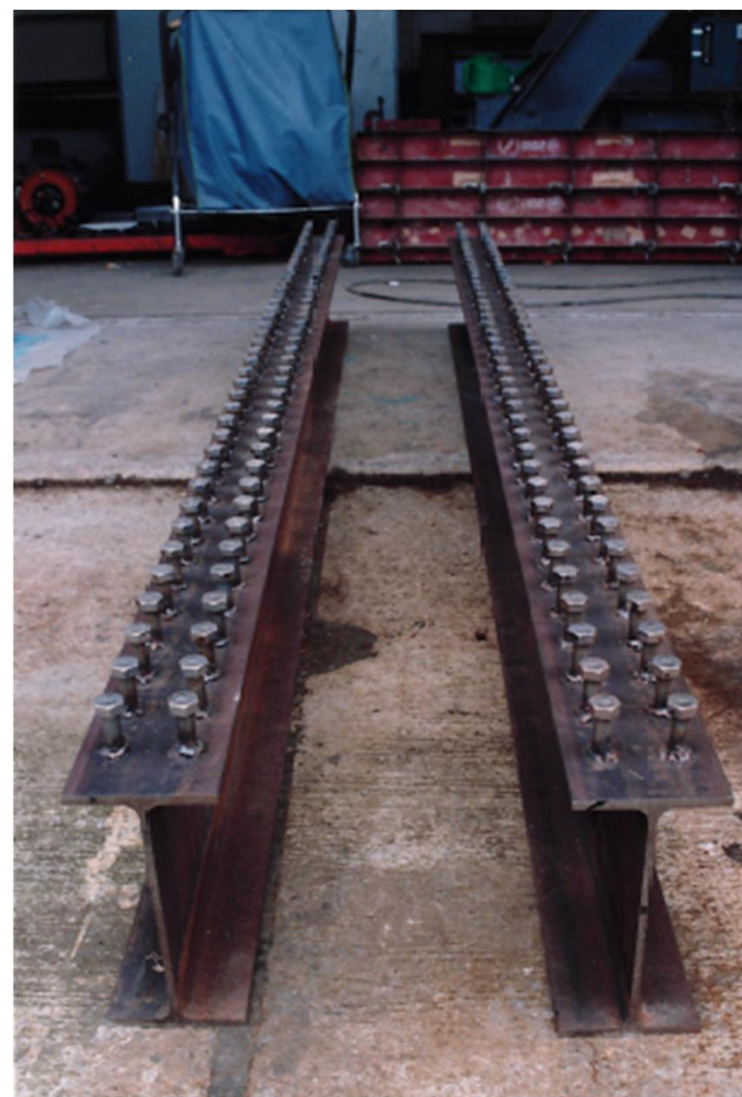
フランジに孔あけ, ねじ切り, 溶接
