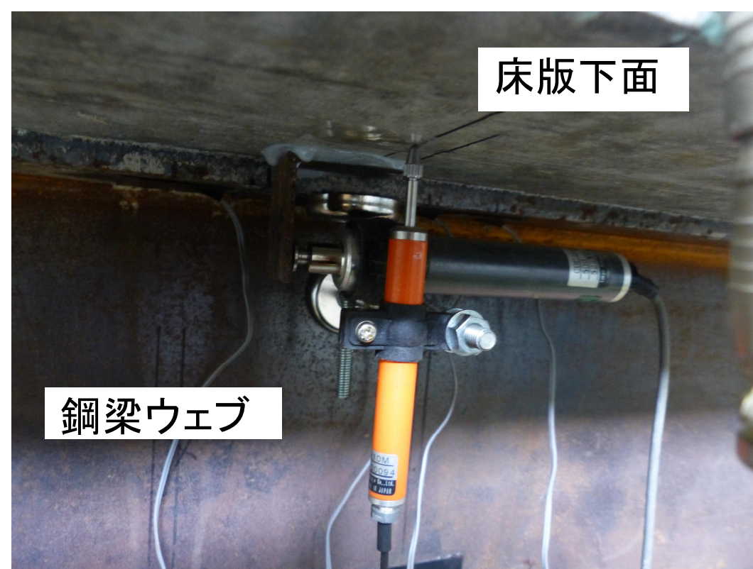
床版と鋼フランジの開き変位計測
