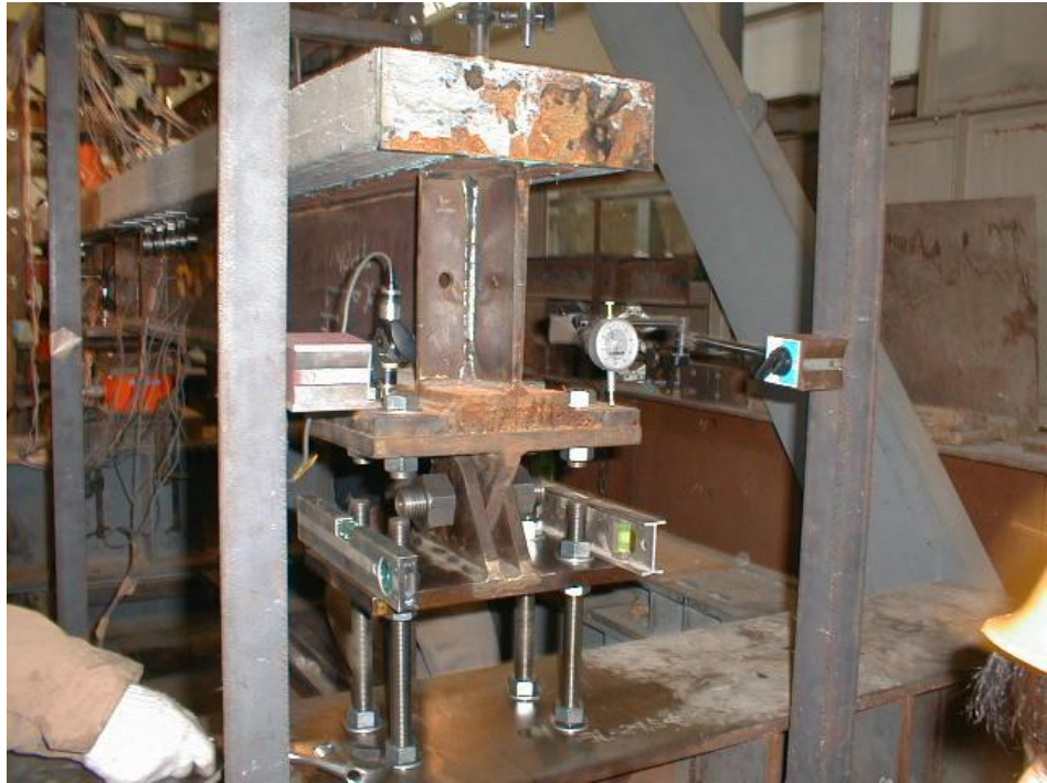
負反力支点(右支点) 高さ調整: 不等沈下による応力の発生を抑制
