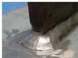
止端を仕上げにくい、応力直角方向にきずがつきやすい
