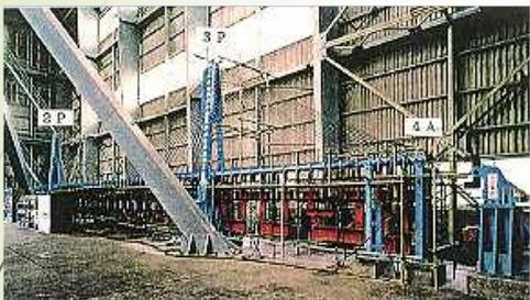
写真-4.1.1 全橋模型による耐荷力試験
