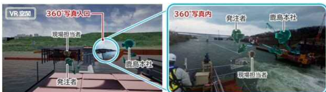
図 2-19 VR 空間内の 360° 写真入口から 360° 写真に入り、現場の状況を確認
