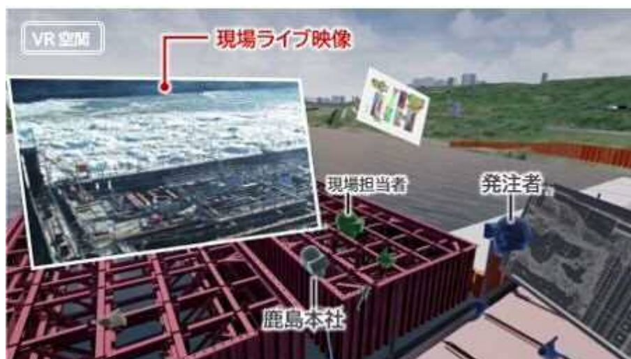
図 2-18 VR 空間内で「BIM/CIM モデル」と「現場ライブ映像」を同時に確認
