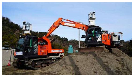
油圧ショベルとクローラキャリア（遠隔操作）
