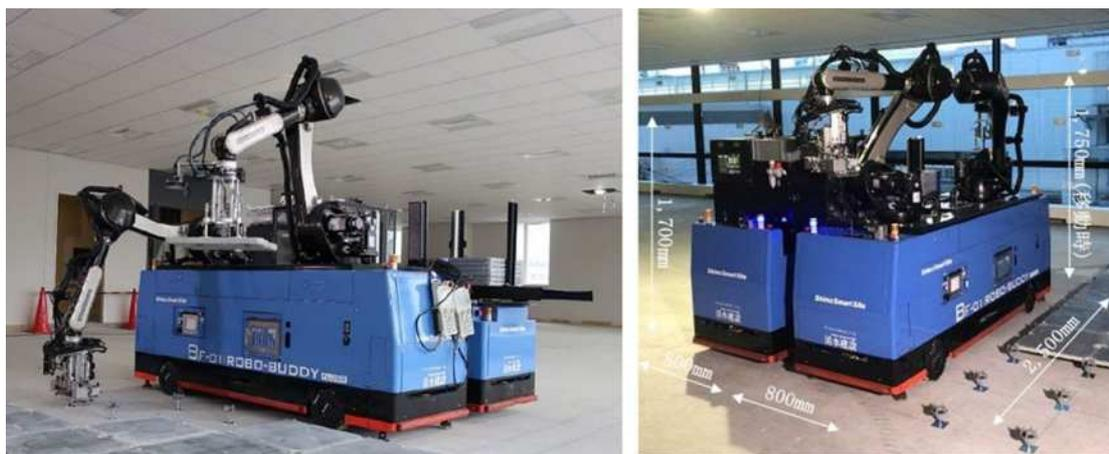
写真-6 Robo-Buddy によるフロア床パネル敷設
