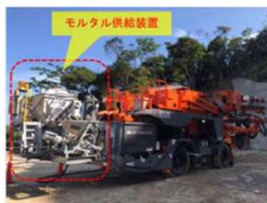
モルタル供給装置搭載状況 (後方)
