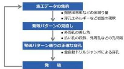
図1：発破の最適化サイクル
