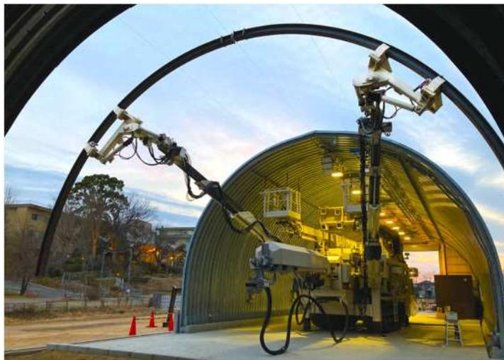
図-10 模擬トンネルにおける全自動鋼製支保工建込みロボット
