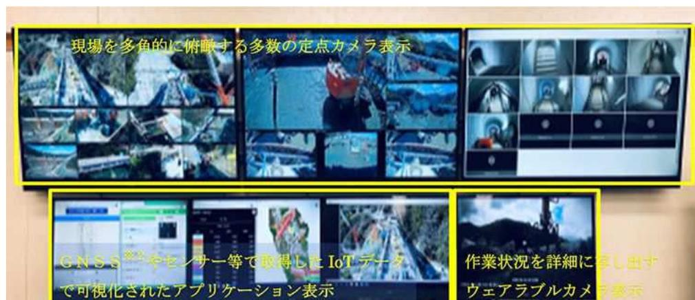
図-8 映像・IoTデータを活用した現場管理システム「T-iDigital Field」を開発、
