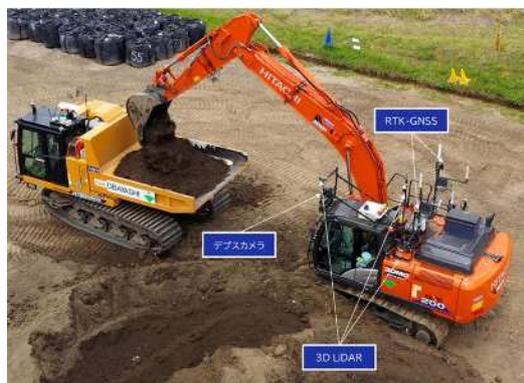
写真-2 バックホウ自律運転システム
