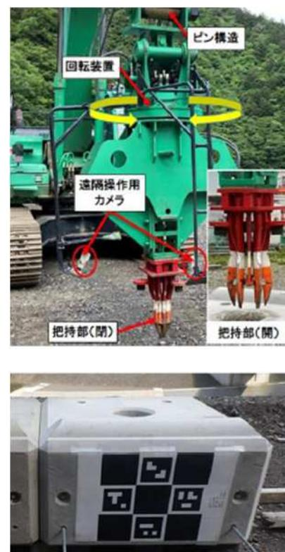
写真-3 ブロック据付状況、専用アタッチメント、ARマーカ付ブロック
