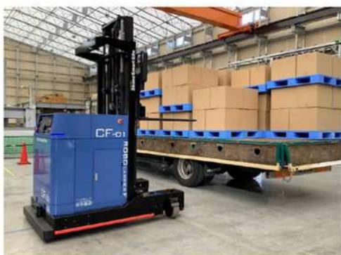
アプリによるロボットへの搬送指示で、荷積み場所への移動、資材の荷取り、搬送場所への移動・荷降ろしまでの一連作業をロボットが自律的に遂行可能
