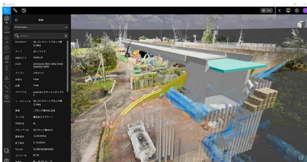
図-6 建設現場のデジタルツインを構築できる「デジタルツインアプリ」を開発
