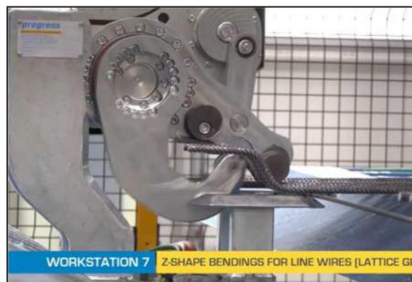
写真-7 自動化製造ラインによる PCa 床版製造 (オーストラリア工場)
