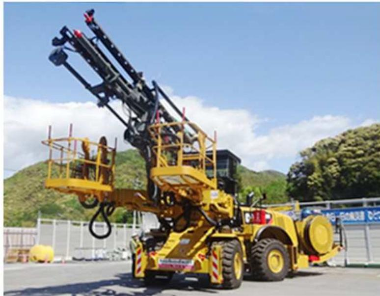
図-17 ロックボルト打設専用機
