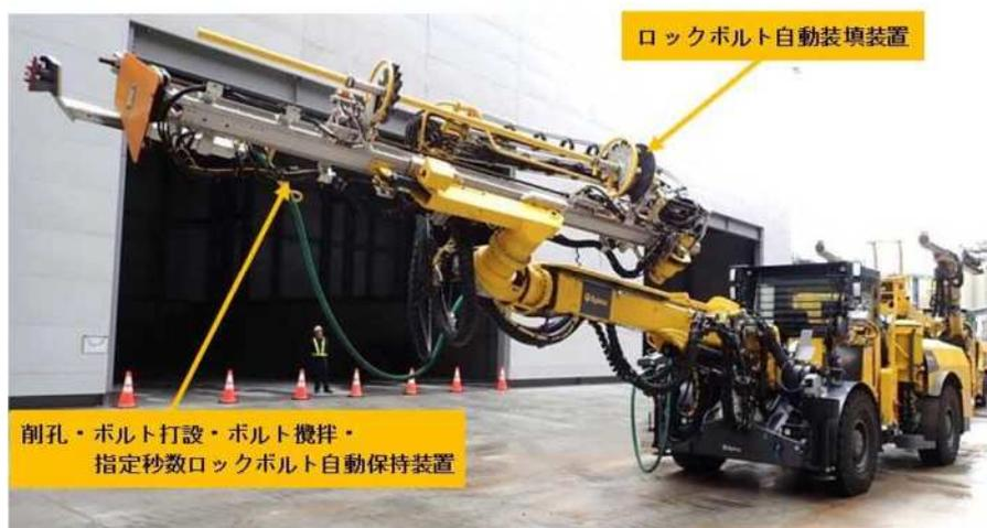
図-19 SF レジンボルト工法対応セミオートロックボルト自動打設機
