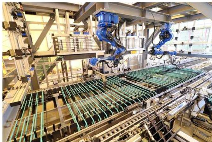
写真-5 ロボットアームによる配筋
