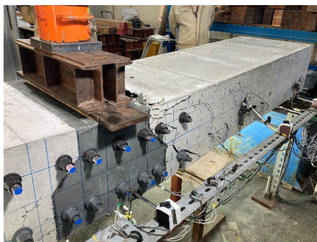
写真-7 供試体の曲げ破壊実験の終局状況
