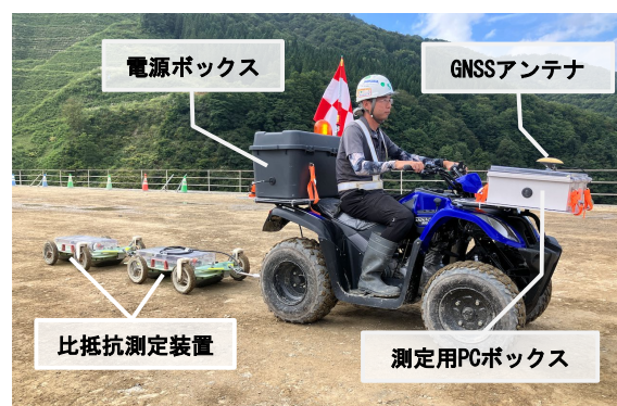
写真-5 成瀬ダムにおける測定状況
