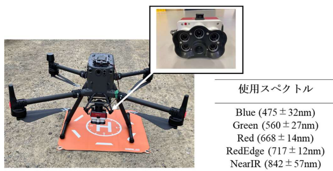
写真-2 マルチスペクトルカメラ搭載 UAV
