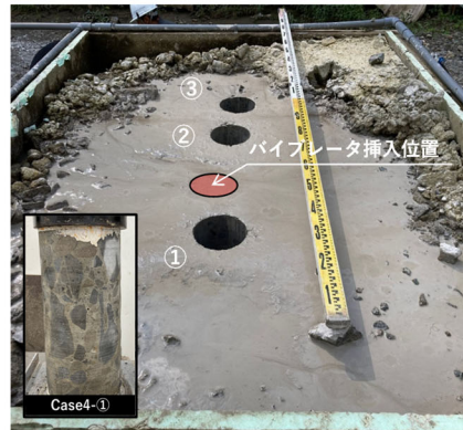
写真-4 \sigma_{91} コアと採取位置 (Case4)
