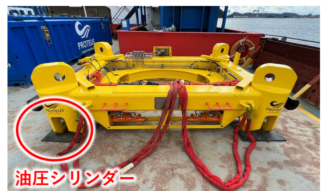
図-11 油圧式遠隔玉掛け・玉外し装置
