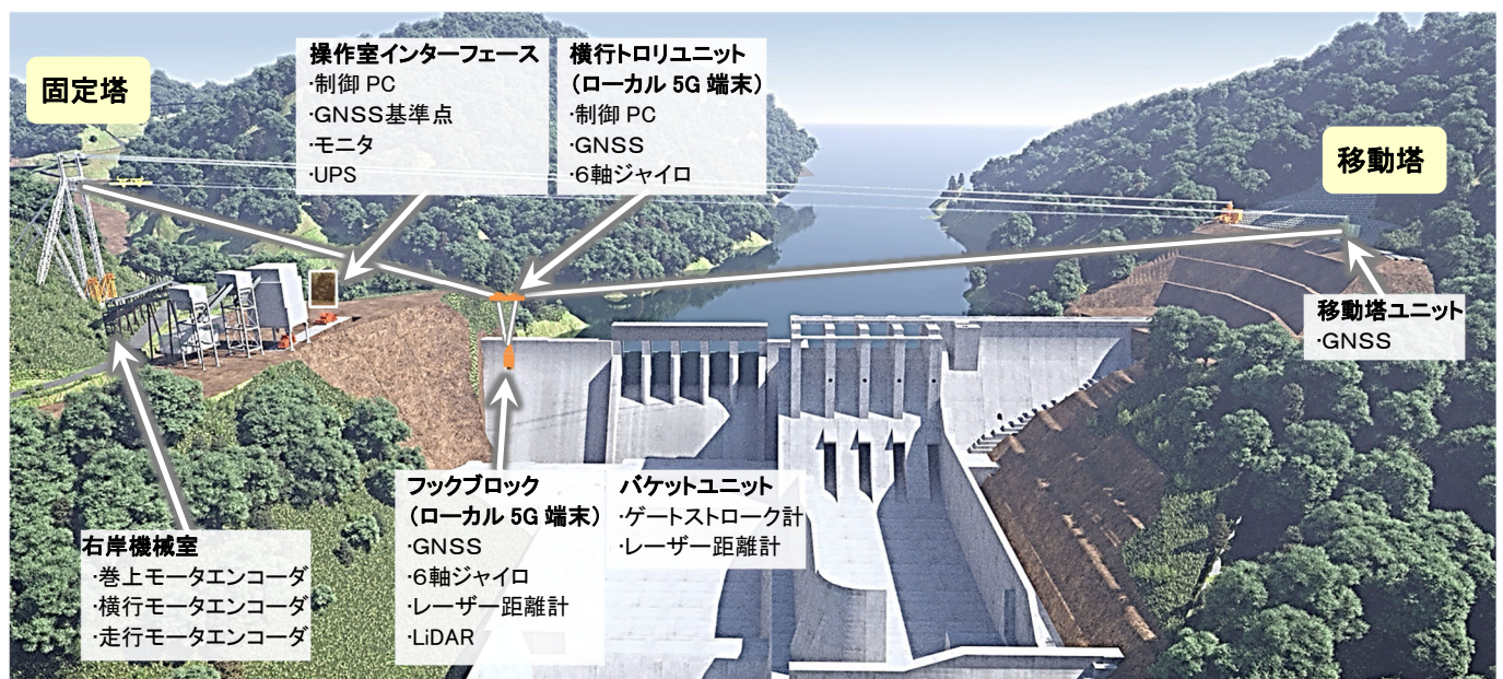
図-3 弧動式ケーブルクレーン自律運転システム構成図
