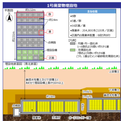
図-1 浅地中処分（ピット処分）の例 1)
