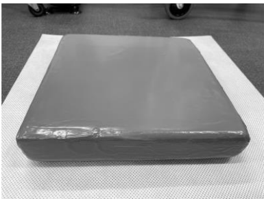
写真-2.2 防食被覆した供試体 (モノクロ写真)
