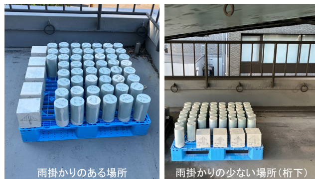
写真-6 テストピースの暴露状況
