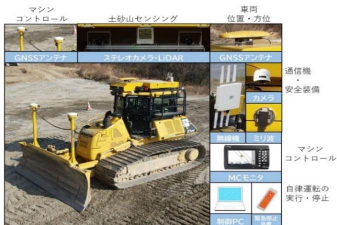
図-3 D61PX-24 ブルドーザ
