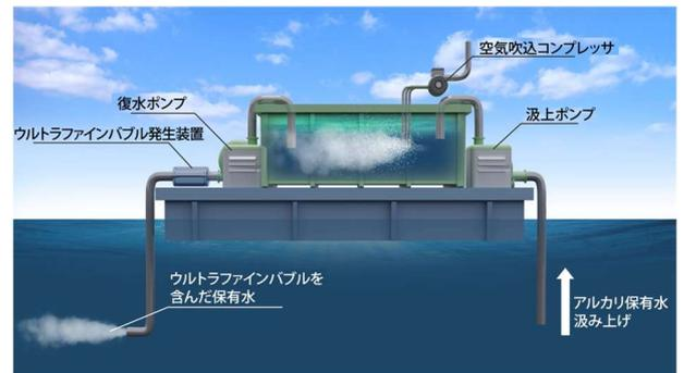
図-1 UFB 水工法の概念図
