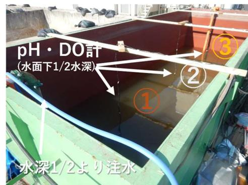
図-7 20m<sup>3</sup>水槽での計測器の配置位置
