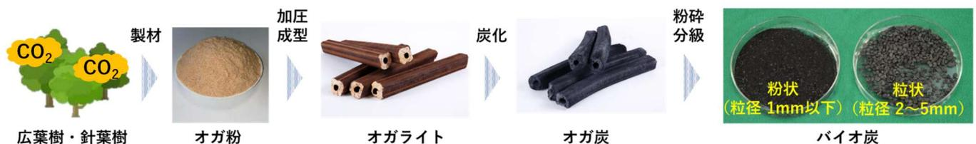
図-1 本開発で使用したバイオ炭の製造工程
