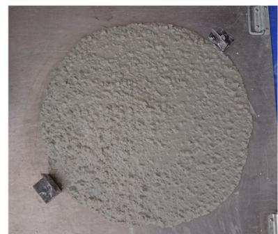
写真-5 コンクリートの広がり状況 (Carbon-Recycle)
