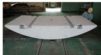
写真-4 インバートの脱型後の外観
