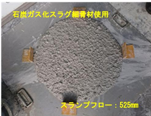
写真-9 コンクリートの広がり状況 (石炭ガス化スラグ細骨材使用)
