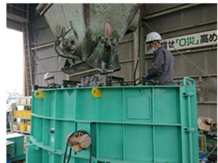
写真-3 セメント・ゼロ型の打込み状況
