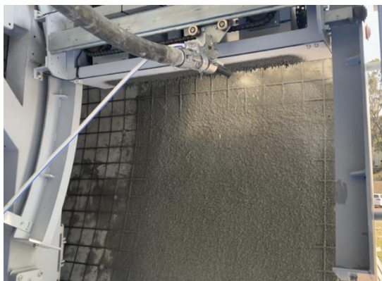
写真-3 吹付け（左）と均し（右）の試験状況
