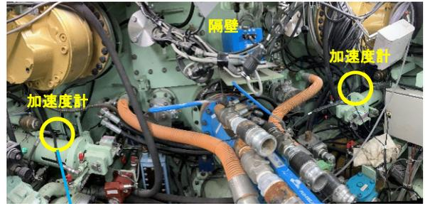
写真 1 機内加速度計（全景）
