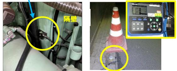
写真 2 機内加速度計，地表面振動レベル計
