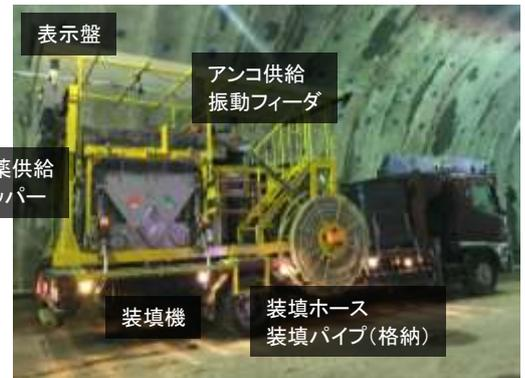
写真-1 爆薬の遠隔装填システム
