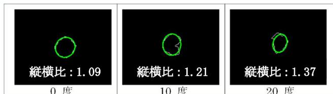
図-9 カメラとの距離による孔の見え方
