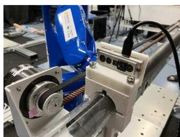
写真-2 ステレオカメラ搭載装填 RB
