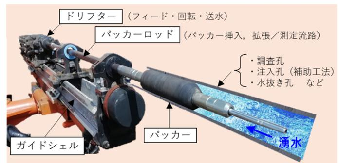
図-4 T-DrillPackerJumboの概要
