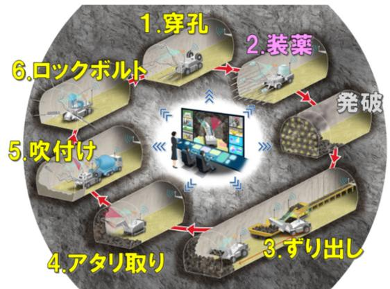
図-1 次世代建設施工システム「A4CSEL for Tunnel」のコンセプト
