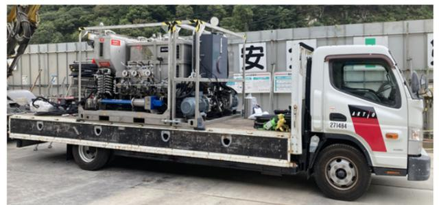
写真-2 移動式製造設備と移動台車
