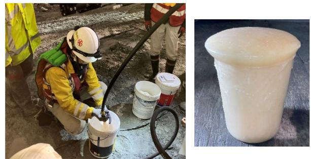
写真-5 比重試験(試料採取と発泡状況)
