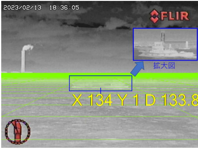
写真-5 AIによる船舶検知状況（赤外線カメラ）
