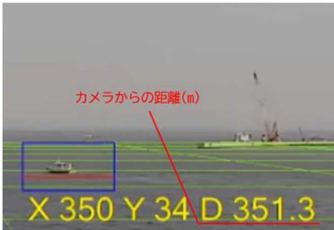
写真-3 交通船の検知状況
