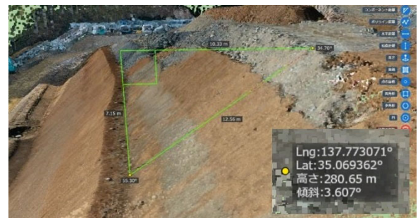
図-6 点群での盛土高さの確認
