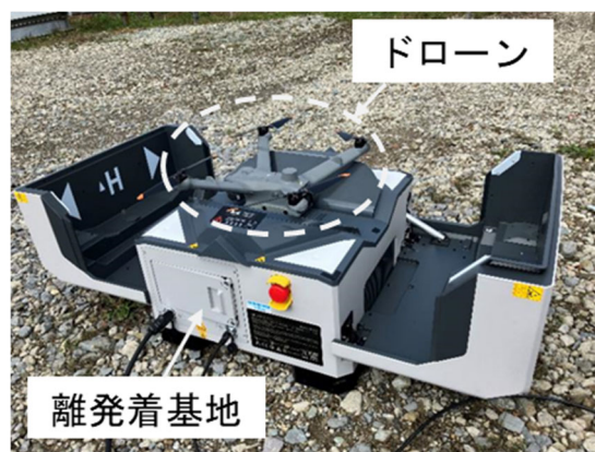
写真-1 離発着基地とドローン
