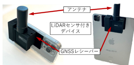
写真-2 GNSS レシーバ付きデバイス
