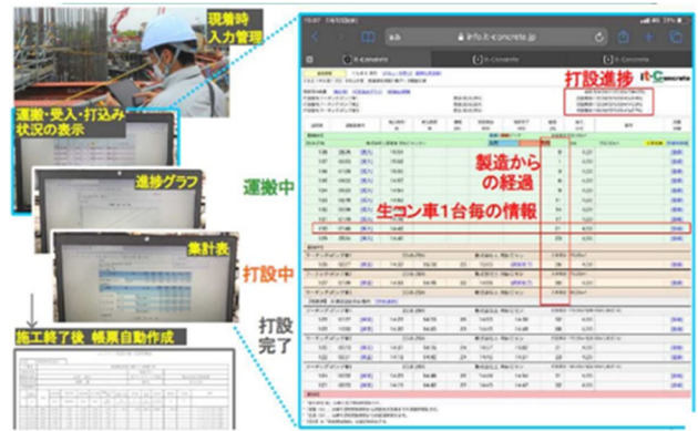
図-2 クラウド共有型品質管理システム it-Concrete
