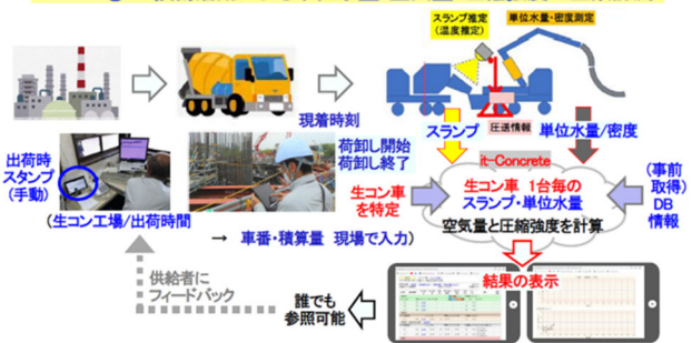
図-7 AI/IoT活用の全数計測手法の概念図
