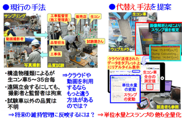
図-9 現場受入れ試験の代替イメージ
