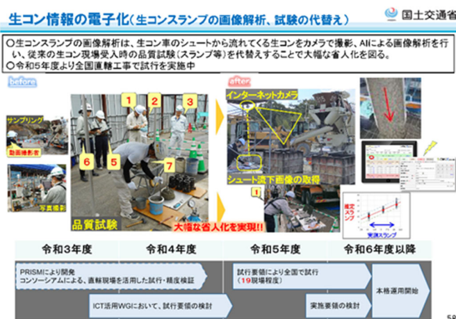
図-11 AI/IoT 手法による試験の代替試行状況 コンクリート生産性向上検討協議会(第 13 回)より 8)
