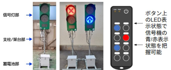
写真-6 信号機とリモコンの外観
