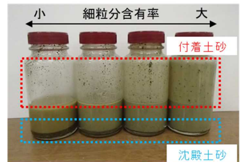
図-1 撮影対象とした解泥土砂
