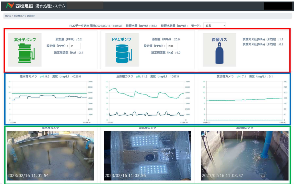
図-9 濁水処理設備遠隔監視用 Web ページ
