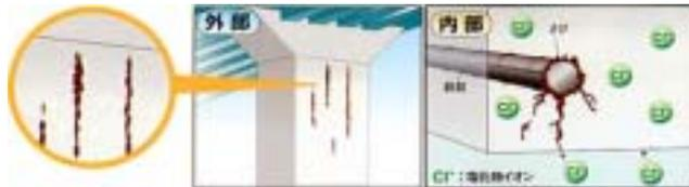
アルカリ骨材反応抑制
