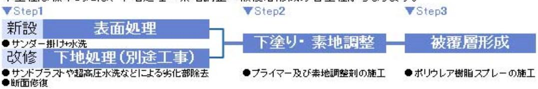
**用途** このような特徴に関して、1997年4月に日本下水道事業団は「民間開発技術審査証明制度」に基づき、下水道施設のコンクリート防食被覆工法として、本工法が、耐薬品性、接着性、優れたクラック追従性、耐久性、防水性、優れた施工性等について開発目標を達成していることを証明しました。(民間開発技術審査証明第806号)
