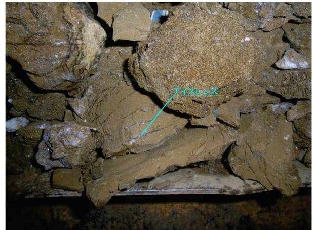
粘性土凍土に形成された アイスレンズ(氷の固まり)
