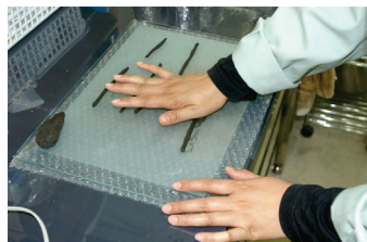
直径3mmの棒状にできず切れ切れになる含水比
