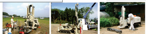
電気式コーン貫入試験装置(提供:CPT技術協会)
