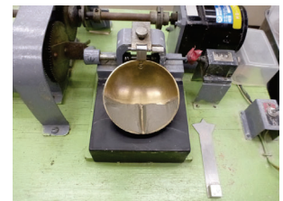
25回の落下回数で1.5cm溝が埋まる含水比
