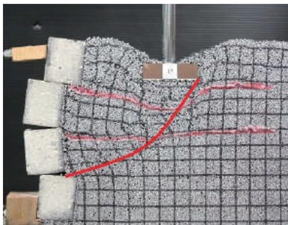
図-8 地盤の変形 (2枚の補強材 g)
