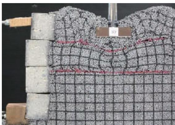
図-7 地盤の変形 (2枚の補強材 p)
