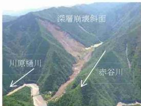
写真-1 赤谷川流域の崩壊地と下流への土砂流出の様子(平成 23 年 9 月の災害直後)。矢印は流向を示す。
