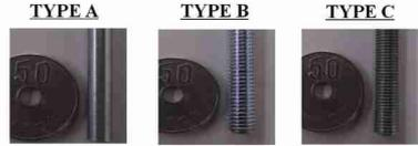
図-17 杭表面における摩擦粗度 (溝切り) 状況
