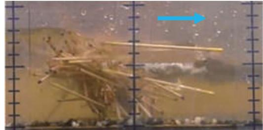
写真-2 橋梁による混合流木の捕捉状況 (Case 4)
