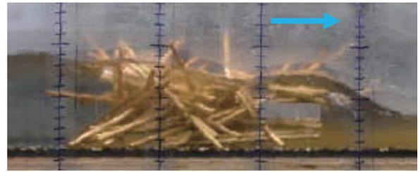
写真-1 橋梁による均一流木の捕捉状況
