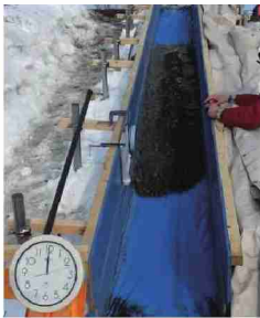
写真-4 土石流流下状況（敷設厚 5cm）
