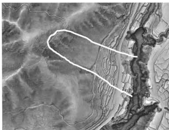
図-2 崩壊前の地形(平成24年)と崩壊地
