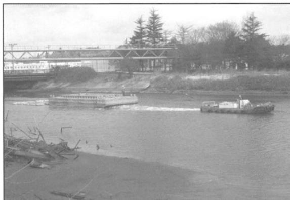
写真-2 土運船の曳航状況
