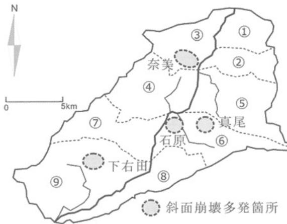
図-4 流域分割と斜面崩壊箇所
